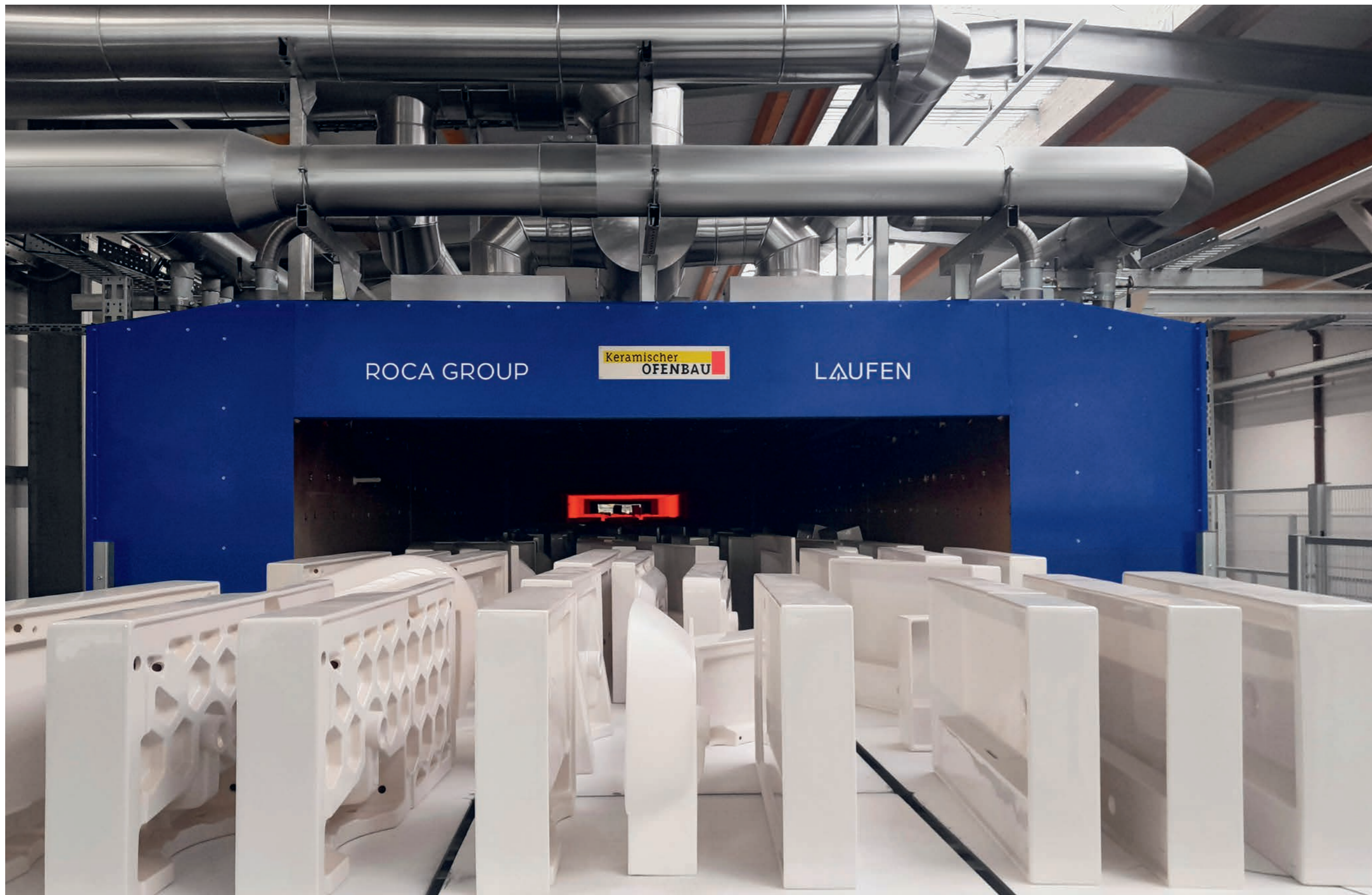
Pierwszy na świecie ELEKTRYCZNY PIEC do produkcji ceramiki sanitarnej rozwinięty przez LAUFEN, Roca Group oraz Keramischer Ofenbau GmbH.
